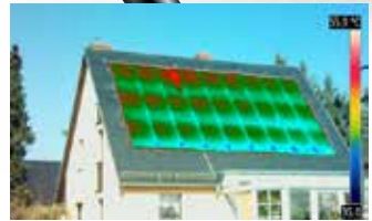
Kontaktfehler im Modul können den Energieertrag der gesamten Anlage erheblich beeinflussen.
